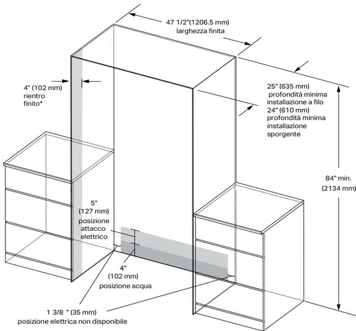
Si consiglia un minimo di 4" (102 mm) di rientro finito che combaci con l'esterno del mobile su tutti i lati e in cima all'apertura di incasso. La zona ombreggiata sarà visibile dopo l'installazione.
